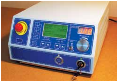
Лазерный аппарат АЛОД-01 «Изумруд» с «зеленой» длиной волны 532 нм
