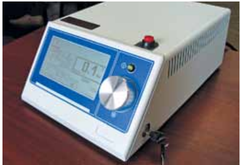
Лазерный аппарат АЛОД-01 «Алмаз» ближнего ИК-диапазона, 810 нм
