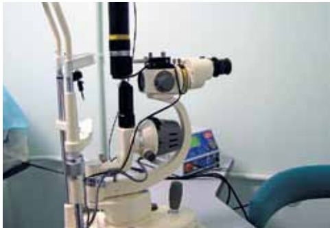
Приставка ПФК-02 для работы лазерного аппарата совместно со щелевой лампой
