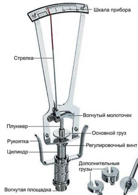
Рис. 10. Тонометр Шюотца с дополнительными грузами
