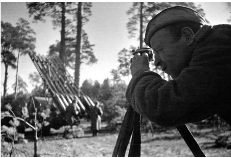
Солдат работает с артиллерийской буссолью на позиции реактивной установки БМ-13 «Катюша».
