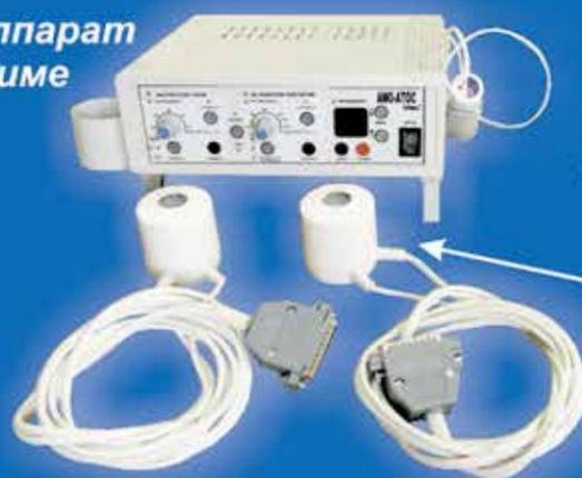
Магнитолазерный излучатель с бегущим характером двух факторов воздействия (магнитное поле и ИК-лазерное излучение)
